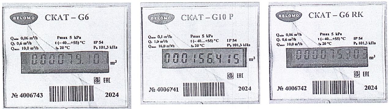
Рисунок 1.2 – Фотография маркировки счетчиков газа ультразвуковых «СКАТ» (изображение носит иллюстративный характер)
